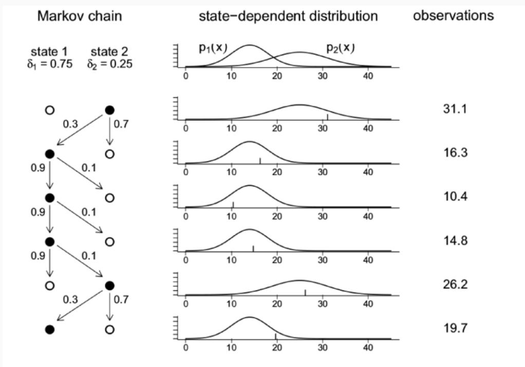
Estrutura do processo de uma distribuição de mistura de dois componentes.
