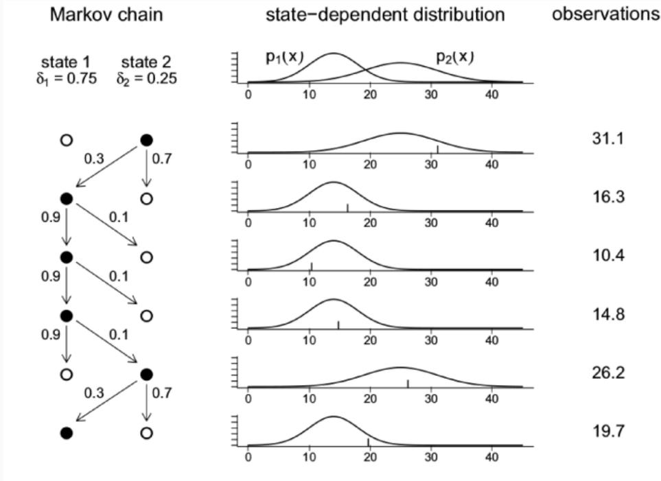
Estrutura do processo de uma distribuição de mistura de dois componentes.
