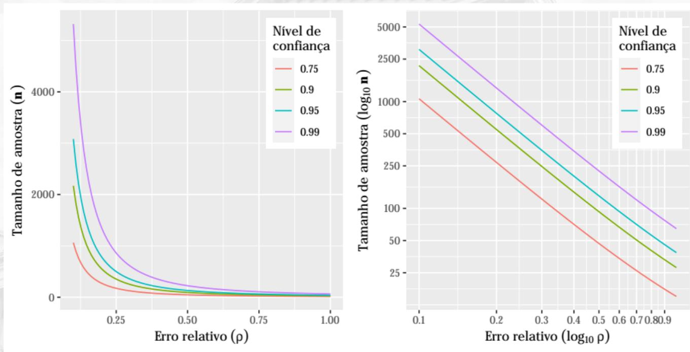
Figura 8. Curvas para determinar o tamanho da amostra para estimação da variância.
